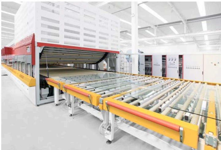
Bildtext: Vorspannofen von NorthGlass für gebogene Scheiben mit einer Länge von bis zu 18 m. (Quelle: © NorthGlass)
