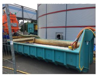
Bildtext: Nachdem das Wasser-Schlamm-Gemisch gesiebt und vom Schlamm befreit wurde, pumpt die Abwasser-Tauchpumpe P 40 CS von AURAS das Restwasser wieder zurück in das Klärbecken. (Bildquelle: Industriewartung Süd)
